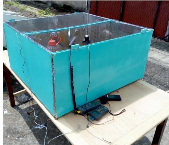
*Fig. 1 : A. Dispositif SODIS amélioré équipé d'un couvercle en plexiglas*
